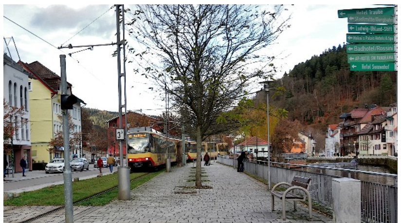
Vor oder nach dem queren der König-Karl-Straße – je nach Fahrtrichtung – wechselt bei der Schranke südlich vom Bahnhof für die S-Bahnen die Stromart, weshalb sie unmerklich für die Fahrgäste eine kleine Teilstrecke im Grünstreifen ohne Energie von oben mit Schwung durchfahren.
