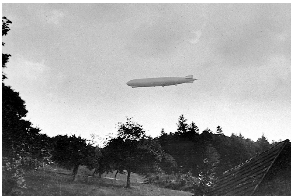
Abb 6: Das Luftschiff war 236,6 m lang und hatte einen Durchmesser von 30,5 m. Fünf Maybach-Ottomotoren mit je 570 PS brachten den Zeppelin auf eine Reisegeschwindigkeit von etwa 115 km/h. Quelle: Archiv Richard Clauer
