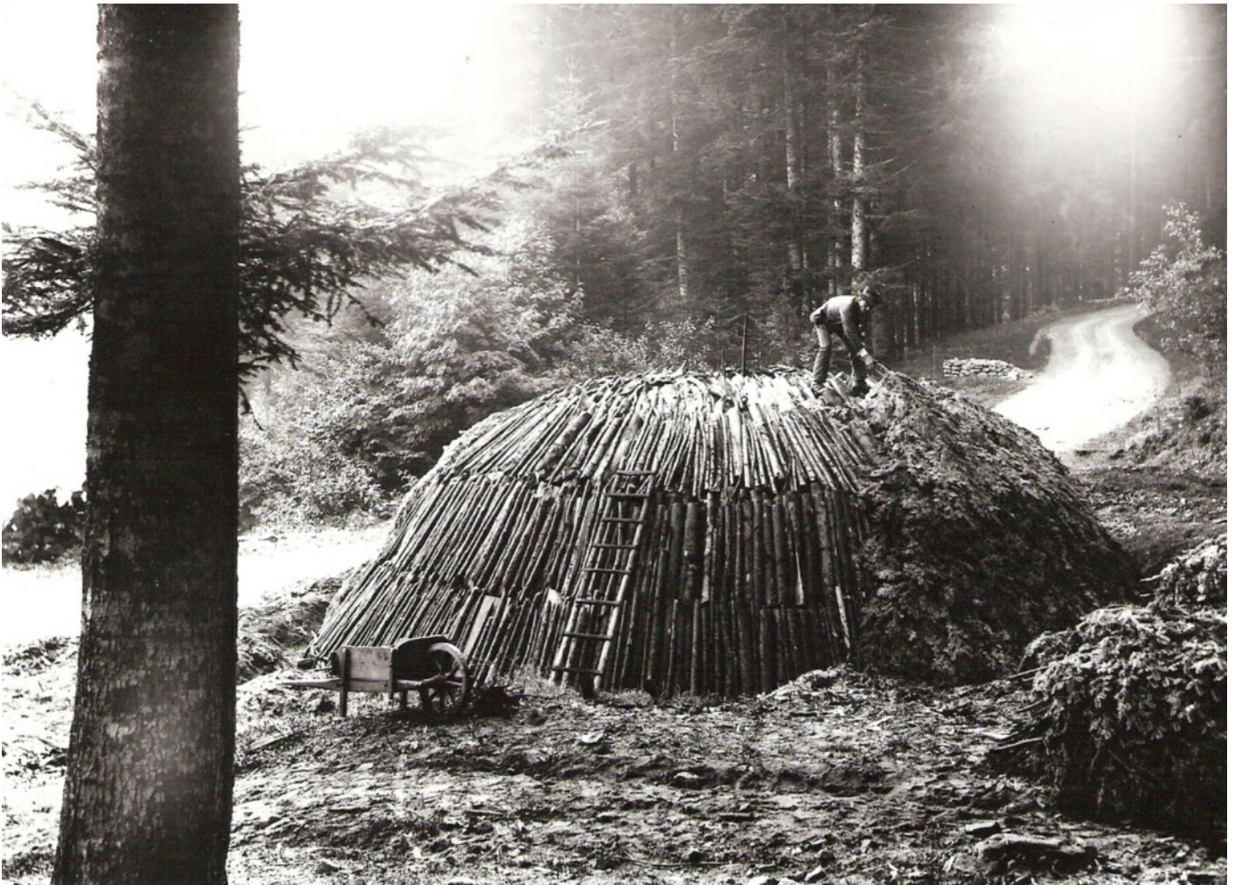
In einem Blumenthal-Foto ist der Köhler beim Aufbau seines Meilers nahe der Agenbacher Sägemühle zu sehen. Bilder: Hans Schabert/Archiv Schabert
